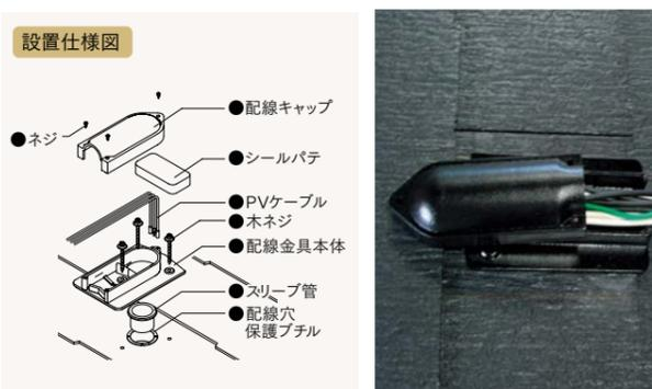
※入線数はCV3.5mm<sup>2</sup>・直径7mm程度の場合を示します。PVケーブルの太さによって入らない場合があります。
