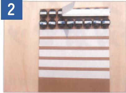
作業用貼付けボードに専用取付具を貼付け、専用取付具の両面テープを剥がします。
