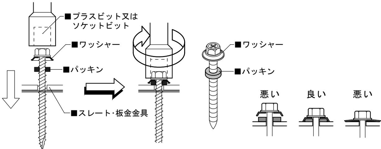
(木ネジの締め付けによる過度の力を、スレートに伝えないためです。)
